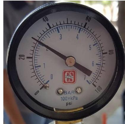
**Figura 11** Manómetro con salida de datos analógica
