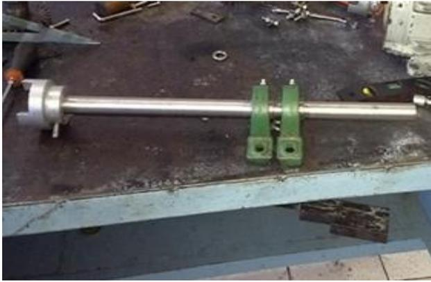
**Figura 2** Chumacera y eje de acero cold rolled
